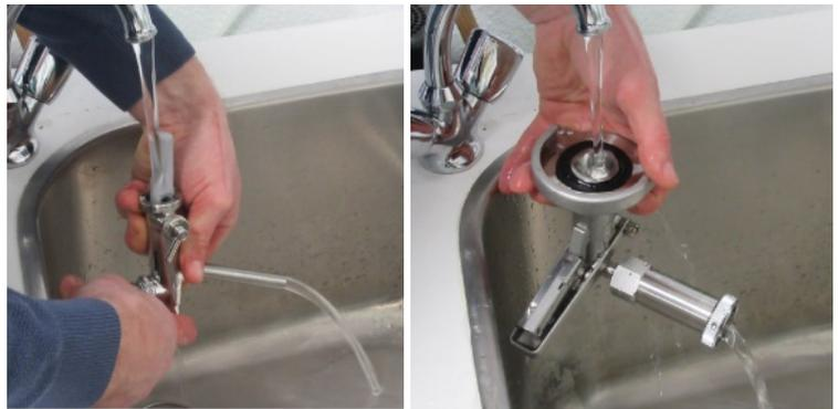
**Spülen** 1x pro Tag bei ständigem Betrieb oder bei kurzzeitigen Schankpausen oder bei Inbetriebnahme: Hierzu trennen Sie bitte die Verbindung zwischen Schankhahn (2) und Stutzen (an der großen Rändelmutter) und spülen Sie äußere Verschmutzungen unter klarem Wasser ab. Ebenso bitte den Schankhahn (2) und den Zapfkopf (1) von innen durchspülen.
